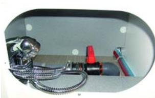
**Vanne d'évacuation des eaux usées (dans un double plancher côté passager)**
