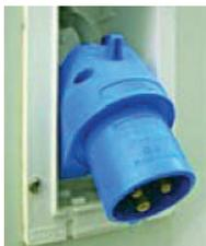
Le raccordement au secteur se fait au moyen d'un câble à brancher à l'extérieur du camping-car sur la prise bleue P17. Cette prise comporte une liaison « terre » obligatoire. Brancher le cordon d'alimentation puis enclencher le disjoncteur situé à proximité du bloc électrique, afin d'alimenter la cellule. Pour éviter tout risque d'endommagement de votre chargeur, s'assurer que l'alimentation fournit une tension de 230 V  $\pm 10$  %.
