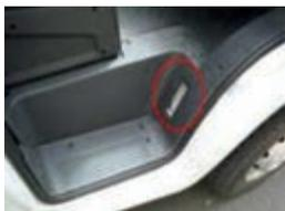
Le numéro de châssis se situe sur le passage de roue avant droit.
