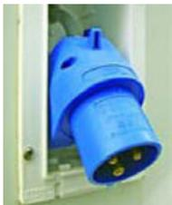
Le raccordement au secteur se fait au moyen d'un câble à brancher à l'extérieur du camping-car sur la prise bleue P17. Cette prise comporte une liaison « terre » obligatoire. Brancher le cordon d'alimentation puis enclencher le disjoncteur situé à proximité du bloc électrique, afin d'alimenter la cellule. Pour éviter tout risque d'endommagement de votre chargeur, s'assurer que l'alimentation fournit une tension de 230 V  $\pm$ 10 %.
