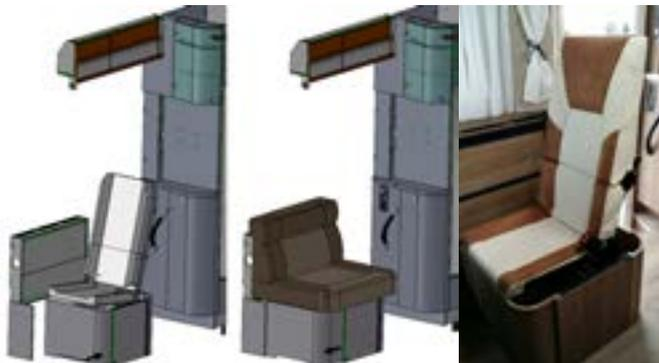
Siège démontable face route de série sur LV7.2CF et LV7.2GJF (coté chauffeur)
