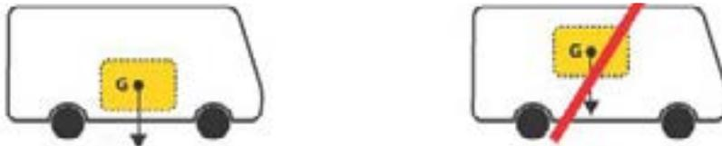
Pour préserver la tenue de route de votre camping-car, le centre de gravité du chargement doit être le plus bas possible. Cela permet de réduire les effets parasites de suspension tels que le roulis, tangage, ...
