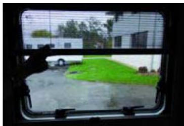
1. Utiliser la rainure pour descendre la moustiquaire.
