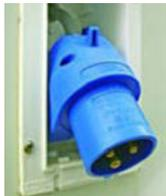
Le raccordement au secteur se fait au moyen d'un câble à brancher à l'extérieur du van sur la prise bleue P17. Cette prise comporte une liaison « terre » obligatoire. Brancher le cordon d'alimentation puis enclencher le disjoncteur situé à proximité du bloc électrique, afin d'alimenter la cellule. Pour éviter tout risque d'endommagement de votre chargeur, s'assurer que l'alimentation fournit une tension de 230 V  $\pm$ 10 %.
