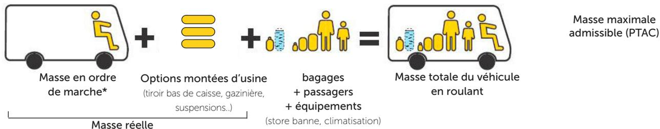
\*La Masse en ordre de marche correspond à la masse du véhicule avec le réservoir de carburant rempli à 90 %, 20 L d'eau propre et une bouteille de gaz remplie à 90 %, y compris la masse du conducteur (75 kg) et les équipements de série du véhicule.
