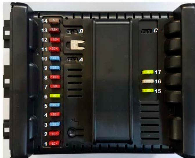
Les By-pass A, B et C permettent de forcer les différentes fonctions sur le bloc électrique en cas de dysfonctionnement de Xperience. L'interrupteur général situé à l'entrée permet de couper l'alimentation 12V. Cet interrupteur est désactivé lorsque le véhicule est raccordé au 230V.
