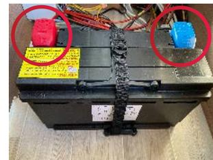
La première règle à respecter est donc de ne pas laisser la batterie déchargée pendant une longue période. Pour pallier ce phénomène, il est nécessaire de ne pas laisser la charge de la batterie descendre en dessous de 11,9 V pendant une longue période, car il y a un risque de décharge profonde, cause d'exclusion de la garantie.
