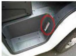
*numéro de châssis se situe sur le passage de roue avant droit*
