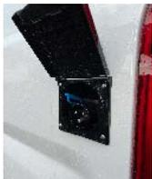
Le raccordement au secteur se fait au moyen d'un câble à brancher à l'extérieur du van sur la prise bleue. Cette prise comporte une liaison « terre » obligatoire. Brancher le cordon d'alimentation puis enclencher le disjoncteur situé à proximité du bloc électrique, afin d'alimenter la cellule. Pour éviter tout risque d'endommagement de votre chargeur, s'assurer que l'alimentation fournit une tension de 230 V  $\pm 10$  %.
