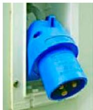
Le raccordement au secteur se fait au moyen d'un câble à brancher au camping-car sur la prise bleue P17. Elle est située directement sur la paroi du véhicule soit dans le local technique accessible par un portillon.
