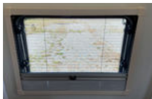
1. Utiliser la rainure pour descendre la moustiquaire.
