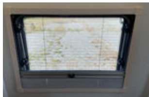
1. Das Fliegengitter in der Gleitschiene herunterziehen.
