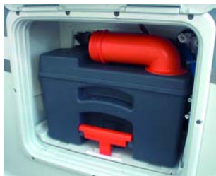
Cassette WC en service
