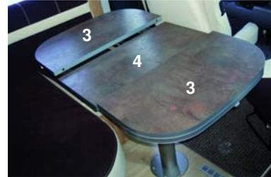
La table est dotée d'un double mouvement de translation dont le réglage s'effectue en desserrant les molettes (1) situées sous la table : une des molettes verrouille le mouvement longitudinal, l'autre le mouvement latéral.
