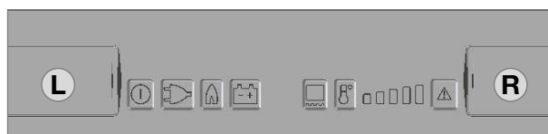
Pannello comande con vano batterie (L, R)
