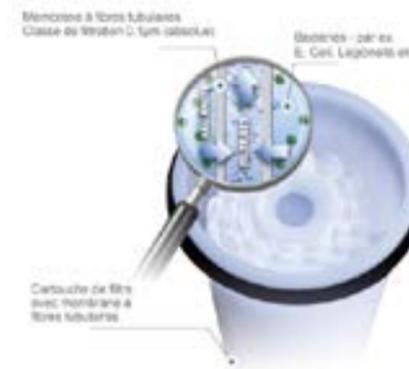
Le filtre de remplissage s'installe entre votre réservoir d'eau et votre tuyau d'eau lors du remplissage du réservoir d'eau propre. Il filtre et élimine les bactéries et champignons pour une rétention bactériologique de 99.99%.
