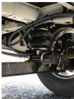
Un renfort de suspension permet de soulager les suspensions avec de l'air et améliore la tenue de route et la stabilité de votre véhicule de loisirs.
