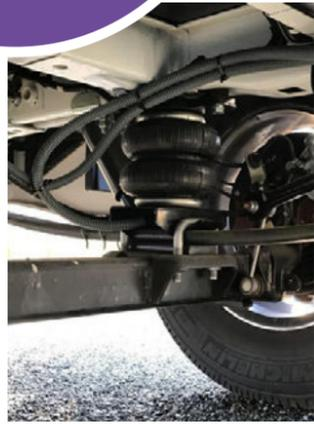
Les renforts des suspensions permettent de soulager les suspensions grâce à l'air et améliorent la tenue de route ainsi que la stabilité de votre véhicule de loisirs.
