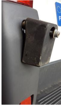
Retirer le bloc caoutchouc placé devant la charnière inférieure gauche.
