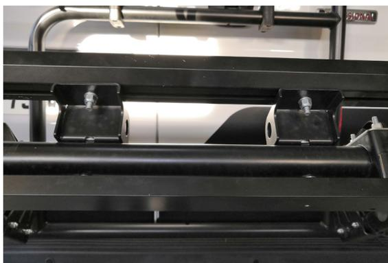
Vis et supports de fixation du rail supplémentaire.
